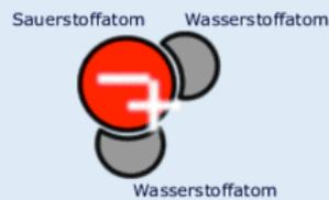
Die elektrische Unausgewogenheit der Wassermoleküle sorgt dafür, dass sich die Teilchen in einem elektrischen Feld ausrichten.
