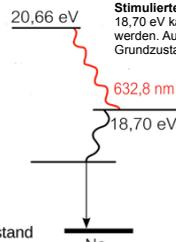
**Stimulierte Emission** auf ein niedrigeres Anregungsniveau des Neons mit  $W_{Ne} = 18,70$  eV kann durch ein Photon der richtigen Wellenlänge ( $\lambda = 632,8$  nm) ausgelöst werden. Aus diesem kurzlebigen Niveau mit  $W_{Ne}$  geht das Neon schnell in den Grundzustand über.
