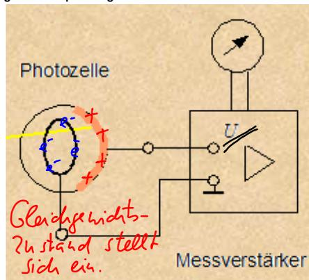
c) Messung der Gegenspannung (Einstein-Versuch)
