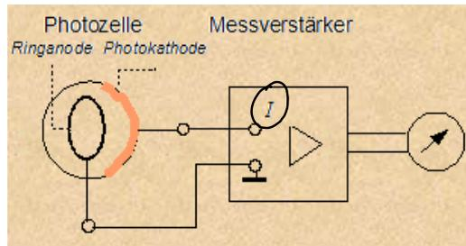
b) Messung der durch den Fotoeffekt aufgebauten Spannung
