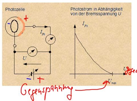
Messwerte zum Versuch Fotoeffekt (Einstein-Versuch)
